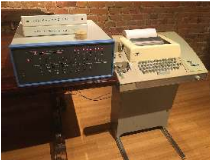
Εικόνα 12: Ο Altair θεωρείται ο πρώτος δημοφιλής μικρο-υπολογιστής και ήταν διαθέσιμος σε οικονομικό κιτ, το οποίο ο χρήστης συναρμολογούσε μόνος του, και στη συνέχεια θα έπρεπε να αγοράσει και τα σχετικά περιφερειακά, εισόδου και εξόδου, όπως ο τηλετύπος για την είσοδο και την έξοδο κειμένου, τα οποία κόστιζαν ακόμη περισσότερο. Ήταν όμως πολύ πιο προσιτός από τους μινι-πολογιστές εκείνης της εποχής και επιπλέον ήταν διαθέσιμος με την επίσης προσιτή γλώσσα προγραμματισμού BASIC.
