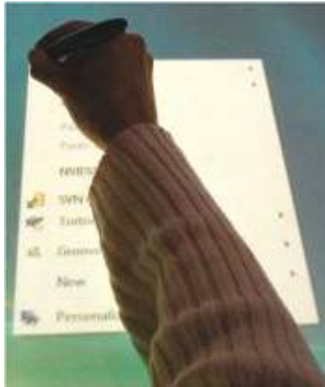
Εικόνα 15: Η άμεση διάδραση με συσκευές αφής έχει το μειονέκτημα ότι το χέρι ή τα δάκτυλα μπορεί να καλύπτουν τον στόχο (ή το αντικείμενο) που θέλουμε να επιλέξουμε ή και να μετακινήσουμε, φαινόμενο γνωστό ως occlusion (έμφραξη), εκτός αν αυτό είναι αρκετά μεγάλο ή χρησιμοποιηθούν τεχνικές που αναιρούν το occlusion.
