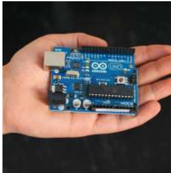
Εικόνα 19: Υπάρχουν πάρα πολλά είδη Arduino, τα οποία εξυπηρετούν διαφορετικές ανάγκες, ανάλογα με την υπολογιστική ισχύ και το μέγεθος, αλλά όλη η σειρά αυτών των μικροελεγκτών έχει σχεδιαστεί με βασικό στόχο τη γρήγορη κατασκευή πρωτοτύπων διάδρασης, τα οποία βασίζονται σε νέες καινοτόμες συσκευές εισόδου και εξόδου.
