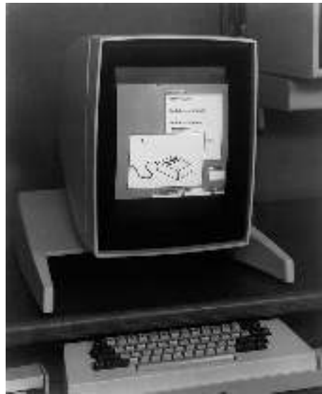
Εικόνα 17: Ο επιτραπέζιος υπολογιστής της Xerox Alto ήταν ένα λειτουργικό πρωτότυπο πάνω στην ιδέα του Dynabook, το οποίο βελτιωνόταν συνεχώς από τους ερευνητές του PARC και οδήγησε τελικά στην κατασκευή του πρώτου σύγχρονου υπολογιστή με γραφική επιφάνεια εργασίας, του Xerox Star.
