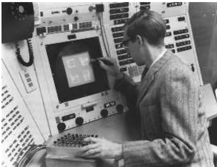
Εικόνα 8: Το σύστημα Sketchpad θεωρείται το πρώτο σημαντικό σύστημα αλληλεπίδρασης ανθρώπου και υπολογιστή με χρήση γραφικών. Οι κεντρικοί υπολογιστές εκείνης της εποχής συνήθως βασίζονταν σε διάτρητες κάρτες ή σε τερματικά γραμμής. Με αυτόν τον τρόπο, το Sketchpad έδειξε ότι είναι εφικτό να έχουμε έναν υπολογιστή, ο οποίος να μην αλληλεπιδρά με τον χρήστη με τον τρόπο που βολεύει μόνο τον υπολογιστή, αφού μέχρι τότε η διάδραση γινόταν ασύγχρονα με εργασίες δέσμης σε διάτρητες κάρτες.
