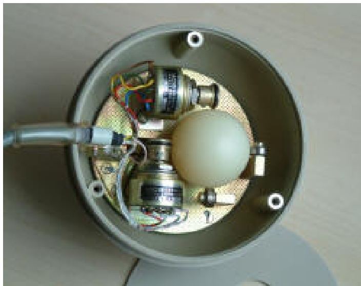
Εικόνα 8: Το αρχικό ποντίκι με τους δύο τροχούς κύλισης, οι οποίοι ακουμπάνε απευθείας πάνω στο τραπέζι μπορούσε να επιλέγει κείμενο, αλλά δεν ήταν βέλτιστο για την ελεύθερη επιλογή σημείων στην οθόνη, γιατί μπορούσε να κινηθεί μόνο σε οριζόντιες και κατακόρυφες ευθείες γραμμές. Οι μηχανικοί της Telefunken, βασισμένοι στη σχεδίαση της μπάλας κύλισης, την οποία γύρισαν ανάποδα, έφτιαξαν το πρώτο εύχρηστο ποντίκι για γραφικά περιβάλλοντα.
