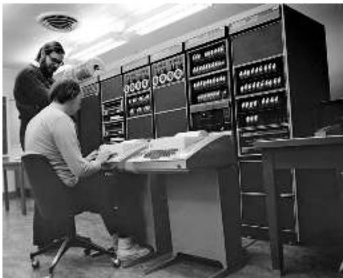
Εικόνα 17: Ο μίνι-υπολογιστής PDP11 της DEC θεωρείται κομβικό σημείο, γιατί ήταν πολύ δημοφιλής σε πανεπιστήμια και ερευνητικά κέντρα, όπου χρησιμοποιήθηκε για την διάδοση του λειτουργικού συστήματος UNIX, της γλώσσας προγραμματισμού C και, κυρίως, των εξομοιωτών που επέτρεψαν την ανάπτυξη νέων συστημάτων για τους μικρο-υπολογιστές που αναπτύχθηκαν στο τέλος της δεκαετίας του 1970 και έφεραν τον υπολογισμό στα σπίτια και στους απλούς χρήστες.
