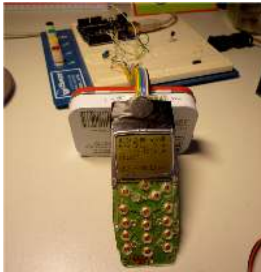
Εικόνα 9: Το Arduino στη βασική του μορφή χρησιμοποιείται κατά το στάδιο της ανάπτυξης λειτουργικών υποδειγμάτων υψηλής πιστότητας για νέα συστήματα διάδρασης, όπως το έξυπνο ρολόι Pebble, αφού επιτρέπει τον γρήγορο έλεγχο, ενώ διευκολύνει και τη μετάβαση στην παραγωγή, καθώς το κύκλωμά του είναι ελεύθερα διαθέσιμο για χρήση και μετατροπή.
