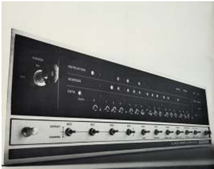
Εικόνα 11: Ακόμη και ο μικρότερος μίνι-υπολογιστής στα τέλη της δεκαετίας του 1960 δεν μοιάζει καθόλου με ένα επιτραπέζιο σύστημα διάδρασης, αφού το βασικό μοντέλο έχει μόνο διακόπτες με φωτάκια και με μια επέκταση μπορεί να συνδεθεί σε έναν τηλετύπο. Αυτό δεν ήταν εμπόδιο για τους ερευνητές του Xerox PARC, οι οποίοι με την τεχνική της εξομοίωσης άρχισαν πάνω σε αυτό το μηχάνημα την κατασκευή του λογισμικού για το Alto που είναι πολύ διαφορετικό, αφού βασίζεται στο ποντίκι και στη γραφική διεπαφή.
