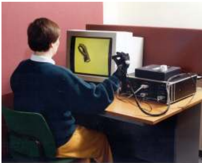
Εικόνα 6: Το γάντι δεδομένων περιέχει αισθητήρες που καταγράφουν την θέση του χεριού και τις κινήσεις των δακτύλων, έτσι ώστε να υπάρχει λεπτομερής χειρισμός σε περιβάλλον εικονικής πραγματικότητας ή σε άλλες εφαρμογές, όπως στη ρομποτική.
