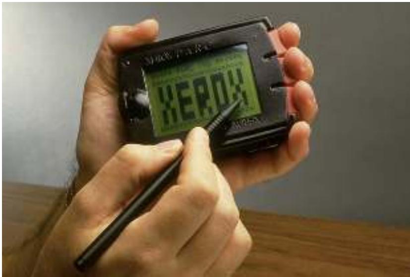
Εικόνα 5: Η συσκευή τύπου Tab ήταν η μικρότερη στην οικογένεια συσκευών διάχυτου υπολογισμού Tab-Pad-Board και ήταν σχεδιασμένη έτσι ώστε να χωράει στην παλάμη και να μπορεί να λειτουργήσει τα κουμπιά μόνο με το ένα χέρι, ενώ επέτρεπε και την αφή με το δεύτερο χέρι, με τη χρήση μιας πένα.
