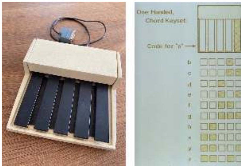
Εικόνα 5: Το πληκτρολόγιο ακόρντων επιτρέπει την είσοδο 31 διαφορετικών κωδικών που καλύπτουν όλο το λατινικό αλφάβητο ή μπορούν να αντιστοιχούν σε τροπικές κεντολές. Σε συνδυασμό με μια αποδοτική συσκευή επιλογής στόχων στην οθόνη, δεν υπάρχει ανάγκη για το παραδοσιακό πληκτρολόγιο, ειδικά για τη συχνή διεργασία της απλής επεξεργασίας έτοιμου κειμένου. Αν και είχε ήδη χρησιμοποιηθεί στο παρελθόν στον τηλετύπο και στην συντομογραφία, ο συνδυασμός με το ποντίκι έχει το εργονομικό πλεονέκτημα ότι ο χρήστης δεν χρειάζεται να μετακινήσει τα χέρια του.
