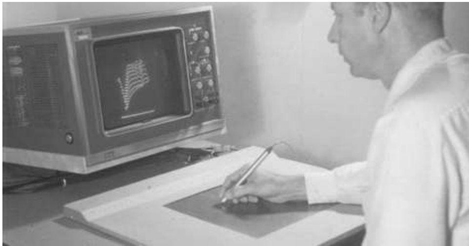
Εικόνα 7: Η πένα έχει το πλεονέκτημα σε σχέση με το ποντίκι ότι μπορεί να χρησιμοποιηθεί και ως συσκευή έμμεσης διάδρασης με τη βοήθεια μιας επιφάνειας ευαίσθητης στη μύτη της πέννας και χωρίς να υπάρχει η ανάγκη αυτή η επιφάνεια να είναι οθόνη.
