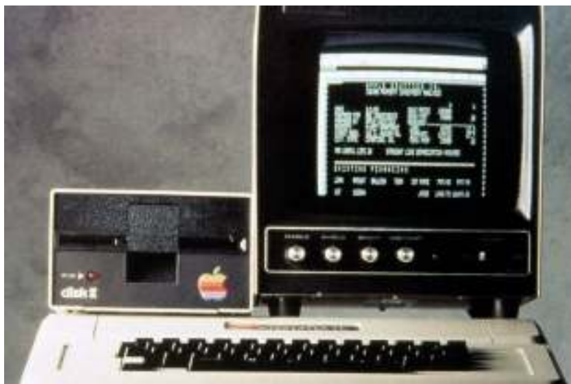
Εικόνα 3: Ο δεύτερος μικρο-υπολογιστής της Apple ήταν άμεσα διαθέσιμος σε μια καλαίσθητη συσκευασία βιομηχανικού σχεδιασμού με πληκτρολόγιο και είχε εισόδους και εξόδους για πολλά διαφορετικά περιφερειακά, όπως δίσκοι και οθόνη. Μπορούσε να συνδεθεί σε τηλεόραση και να αποθηκεύσει προγράμματα σε ένα μαγνητόφωνο κασέτας ήχου, οπότε το κόστος ήταν χαμηλό και έγινε αμέσως δημοφιλής, ενώ έμεινε σε παραγωγή για περισσότερα από δεκαπέντε χρόνια.
