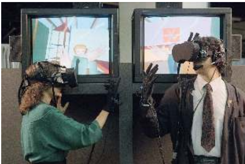
Εικόνα 22: Το γάντι δεδομένων περιέχει αισθητήρες, οι οποίοι καταγράφουν τη θέση του χεριού και τις κινήσεις των δακτύλων, έτσι ώστε να υπάρχει λεπτομερής χειρισμός στο περιβάλλον εικονικής πραγματικότητας, το οποίο απεικονίζεται στη μάσκα. Η δυνατότητα του χρήστη όχι μόνο να πλοηγηθεί, αλλά κυρίως να εκφραστεί σωματικά και να χειριστεί με μεγάλη ακρίβεια τον εικονικό εαυτό και το περιβάλλον του, στο οποίο συνεργάζεται και με άλλους χρήστες, ήταν τα θεμέλια στο πρώτο εμπορικό σύστημα εικονικής πραγματικότητας.
