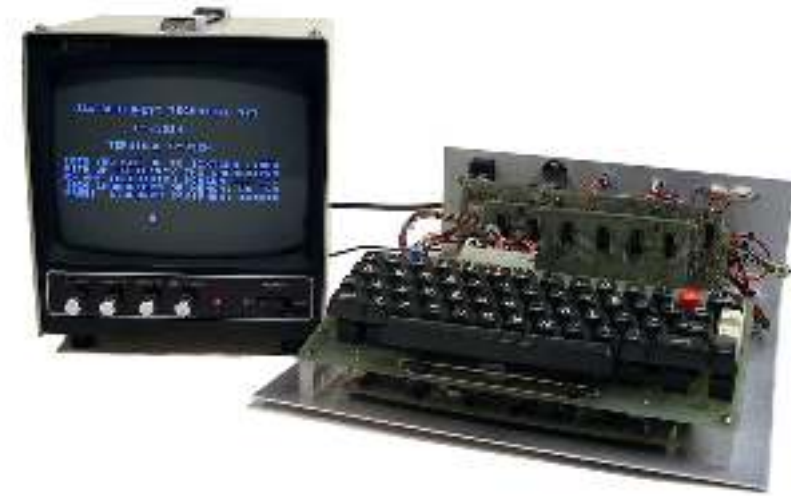
Εικόνα 9: Η μεγάλη διαθεσιμότητα των συσκευών τηλεόρασης τη δεκαετία του 1970 επέτρεψε σε πολλούς ερασιτέχνες να συνδέσουν ένα πληκτρολόγιο για να γράψουν κείμενο στην οθόνη της. Αν και οι συσκευές αυτές δεν είχαν κάποιο επεξεργαστή, στη συνέχεια επεκτάθηκαν για να συνδεθούν με τους πρώτους μικρο-υπολογιστές.
