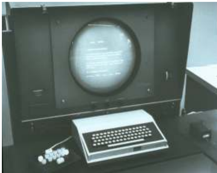
Εικόνα 3: Το σύστημα NLS που παρουσιάστηκε τελικά είχε ποντίκι με τρία κουμπιά, ακόντια πέντε πλήκτρων και ορθογώνια οθόνη. Μερικά χρόνια νωρίτερα η ερευνητική ομάδα ξεκίνησε με το διαθέσιμο υλικό εκείνης της εποχής, που ήταν η στρογγυλή οθόνη του ραντάρ και ένα χειροποίητο ποντίκι με ένα πλήκτρο, έτσι ώστε να κατασκευάσει μια πρώτη έκδοση για το λογισμικό διάδρασης και να διαπιστώσει στην πράξη ποιες αλλαγές απαιτούνται για την επόμενη έκδοση των συσκευών διάδρασης σε μια επαναληπτική διαδικασία σχεδίασης.
