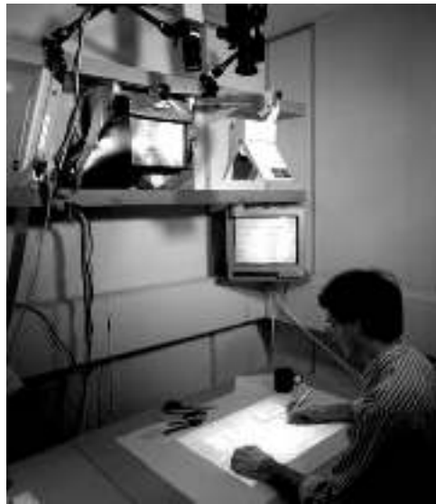
Εικόνα 13: Το σύστημα Digital Desk δημιουργήθηκε είχε στόχο να φέρει πάνω στο τραπέζι τις δυνατότητες διάδρασης μεταξύ του ψηφιακού και φυσικού κόσμου, ακριβώς δηλαδή, το αντίθετο από την κατεύθυνση που ακολουθεί ο επιτραπέζιος υπολογισμός με την γραφική επιφάνεια εργασίας.
