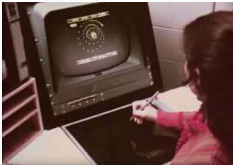
Εικόνα 8: Το σύστημα οπτικού προγραμματισμού Genesys απευθύνεται σε σχεδιαστές γραφικών κίνησης, οπότε βασίζεται στην οικεία για αυτούς πένα και σε λογισμικό σχεδίασης αντικειμένων. Παρουσιάζει καινοτόμες λειτουργίες διάδρασης, όπως είναι η χειρονομία για τη σχεδίαση μιας τροχιάς κίνησης, όπου εκτός από την ίδια την τροχιά καταγράφεται και ο ρυθμός.
