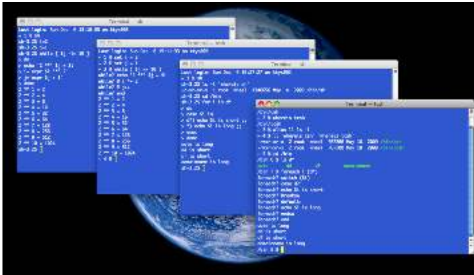
Εικόνα 18: Η διεπαφή του πυρήνα του λειτουργικού συστήματος UNIX ονομάστηκε κέλυφος, καθώς κρύβει τις λεπτομέρειες της υλοποίησης και παρέχει μια προσβάσιμη διάδραση για τον χρήστη. Εκτός από τις βασικές λειτουργίες του συστήματος, παρέχει και μια απλή γλώσσα προγραμματισμού μεταγλώττισης, η οποία επιτρέπει τη φορητότητα των προγραμμάτων του χρήστη σε παρόμοια συστήματα.
