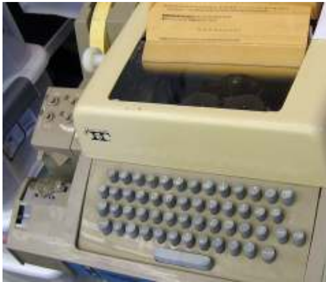
Εικόνα 3: Το μοντέλο 33 της εταιρείας Teletype αποτελεί μια ολοκληρωμένη συσκευή εισόδου και εξόδου και ήταν πολύ δημοφιλής με τους μίνι-υπολογιστές της δεκαετίας του 1960, καθώς και με τους πρώτους μικρο-υπολογιστές, αφού για πολλά χρόνια ήταν η πιο οικονομική και οικεία λύση. Ο χρήστης μπορούσε να αλληλεπιδράσει με τον υπολογιστή με το πληκτρολόγιο και να δει την έξοδο να τυπώνεται στο χαρτί, ενώ η διάτρητη χαρτοταινία επέτρεπε τόσο την αποθήκευση δεδομένων, όσο και τη φόρτωση τους.
