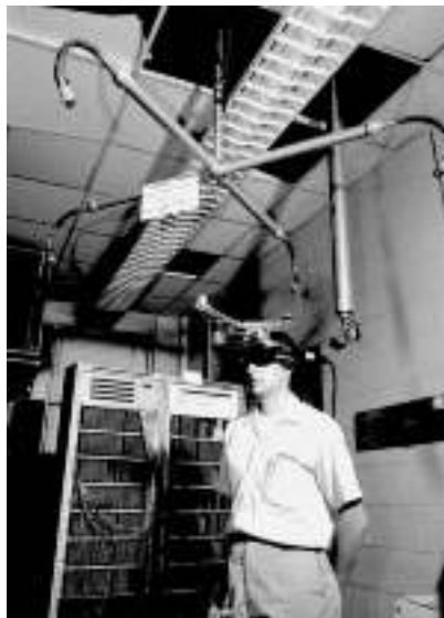
Εικόνα 12: Το Σπαθί του Δαμοκλή θεωρείται μια θεμελιώδης τεχνολογία για τη δημιουργία της εικονικής πραγματικότητας, όπου τα γραφικά στην οθόνη ακολουθούν την κίνηση του κεφαλιού. Το αρχικό σύστημα βασιζόταν στην προβολή βίντεο από μια βιντεοκάμερα που βρισκόταν στη βάση ενός ελικοπτέρου έτσι ώστε να διευκολύνει την προσγείωση σε δύσκολες συνθήκες.
