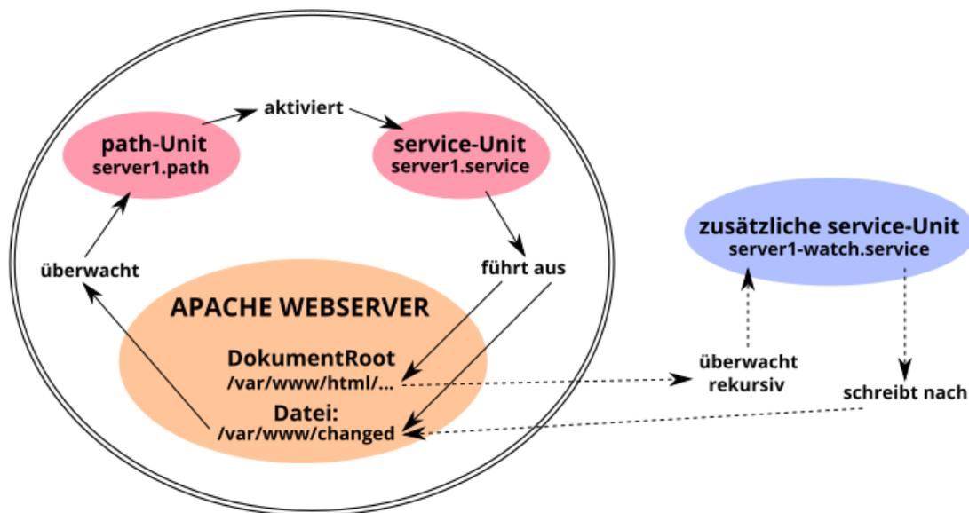
Abbildung 66: path-Unit Funktion
