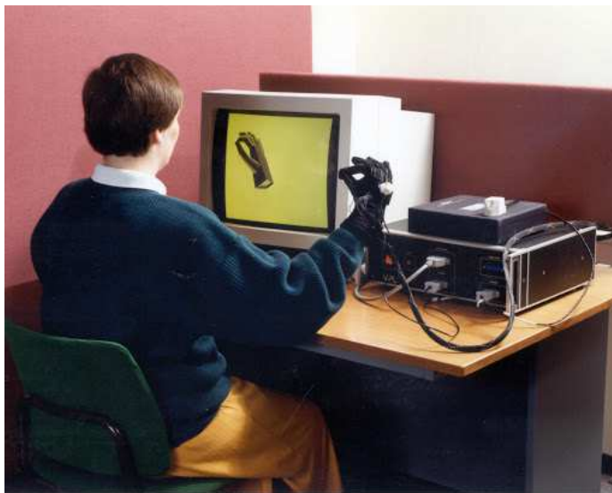
Εικόνα 6: Το γάντι δεδομένων περιέχει αισθητήρες που καταγράφουν την θέση του χεριού και τις κινήσεις των δακτύλων, έτσι ώστε να υπάρχει λεπτομερής χειρισμός σε περιβάλλον εικονικής πραγματικότητας ή σε άλλες εφαρμογές, όπως ρομποτική.
