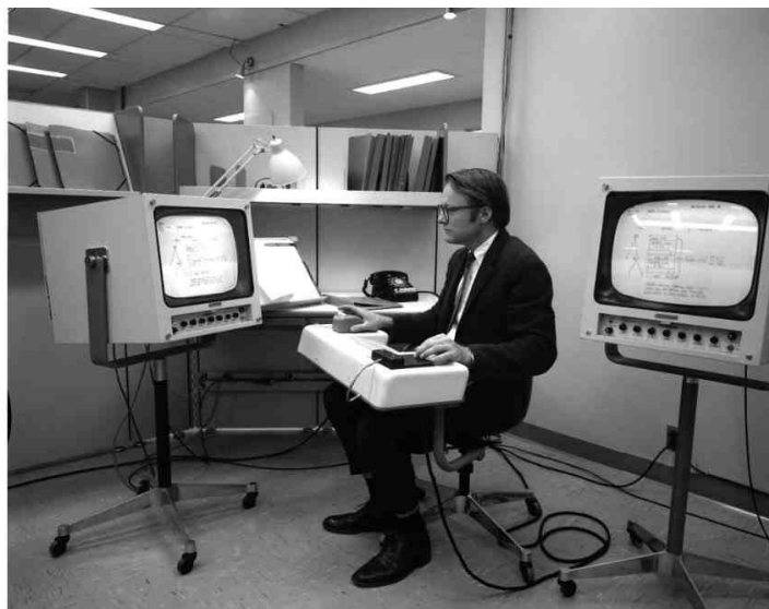
Εικόνα 14: Η πολύωρη παραμονή σε έναν σταθμό εργασίας έχει αρνητικές επιπτώσεις στον άνθρωπο, που μπορούν να αμβλυνθούν με έναν πιο εργονομικό σχεδιασμό των συσκευών αλλά και του λογισμικού. Το σύστημα NLS βασίζεται σε ειδικά ολοκληρωμένο με τον σταθμό εργασίας κάθισμα, καθώς και σε αποδοτική διάδραση για εκπαιδευμένο χρήστη, οπότε όλες αυτές οι παράμετροι θα πρέπει να αξιολογηθούν συνδυαστικά μαζί με την κατασκευή του λογισμικού διάδρασης.
