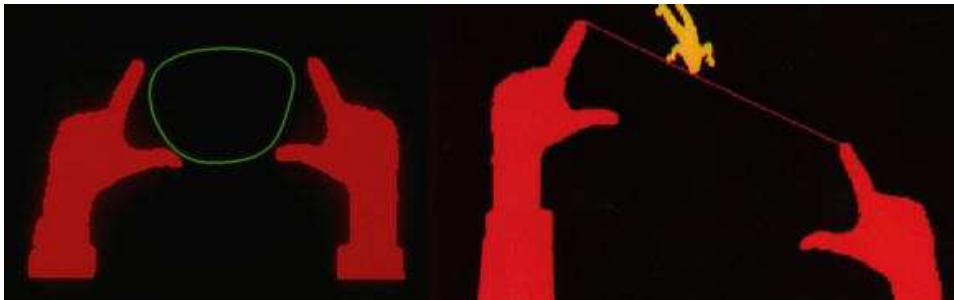
Εικόνα 13: Το ερευνητικό σύστημα Videoplac του Myron Krueger τοποθετεί τη σιλουέτα του χρήστη μέσα σε ένα συμμετοχικό διαδραστικό περιβάλλον, όπου δεν υπάρχει διάκριση ανάμεσα σε χρήστες και γραφικά, με τη χρήση κάμερας σε πραγματικό χρόνο και χωρίς να μεσολαβεί κάποια συσκευή έμμεσης διάδρασης. Σε αντιδιαστολή με τα πρώτα συστήματα εικονικής πραγματικότητας εκείνης της περιόδου, αυτό το σύστημα χαρακτηρίζεται από τον δημιουργό του ως τεχνητή πραγματικότητα, η οποία αρχικά υλοποιήθηκε με αναλογικά φίλτρα και κινηματογραφικές τεχνικές πριν περάσει σε τεχνολογίες υπολογιστικής όρασης.
