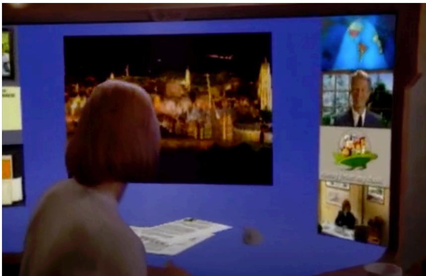
Εικόνα 10: Στις αρχές της δεκαετίας του 1990 η Sun παρουσίασε ένα βίντεο με μια μεγάλη επιτραπέζια συσκευή χειρονομίας, η οποία βασίζεται στην συνεργασία μέσω τηλεδιάσκεψης με βίντεο, όπου η πρωταγωνίστρια εργάζεται από το σπίτι της γιατί έχει κρουστικό. Το βίντεο υπόδειγμα χρησιμοποιεί την τεχνική της μπλε οθόνης για να εισάγει τις πρόσθετες ροές βίντεο πάνω στο αρχικό σκηνοθετημένο βίντεο.
