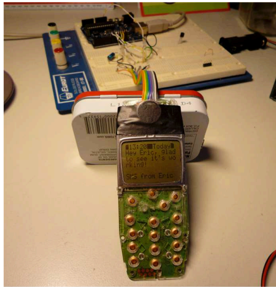
Εικόνα 9: Το Arduino στη βασική του μορφή χρησιμοποιείται κατά το στάδιο της ανάπτυξης λειτουργικών υποδειγμάτων υψηλής πιστότητας για νέα συστήματα διάδρασης, όπως το έξυπνο ρολόι rebble, αφού επιτρέπει τον γρήγορο έλεγχο, ενώ διευκολύνει και τη μετάβαση στην παραγωγή, καθώς το κύκλωμά του είναι ελεύθερα διαθέσιμο για χρήση και μετατροπή.
