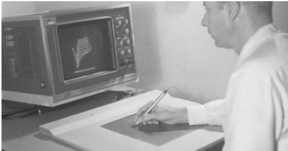
Εικόνα 7: Η πένα έχει το πλεονέκτημα σε σχέση με το ποντίκι ότι μπορεί να χρησιμοποιηθεί και ως συσκευή έμμεσης διάδρασης με την βοήθεια μιας επιφάνειας ευαίσθητης στην μύτη της πένας και χωρίς να υπάρχει η ανάγκη αυτή η επιφάνεια να είναι οθόνη.
