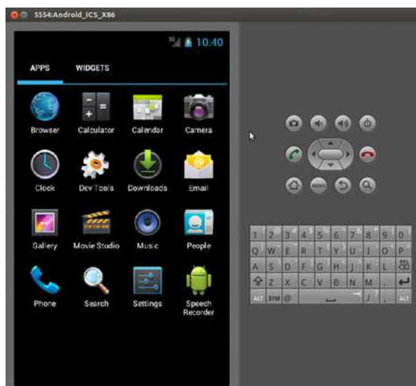
Εικόνα 11: Ο εξομοιωτής για τις κινητές συσκευές με λειτουργικό σύστημα Android, εκτός από την εξομοίωση της επεξεργασίας των δεδομένων, περιλαμβάνει και μια προσομοίωση κάποιων κουμπιών και διαδράσεων που συνήθως έχουν τα έξυπνα κινητά.
