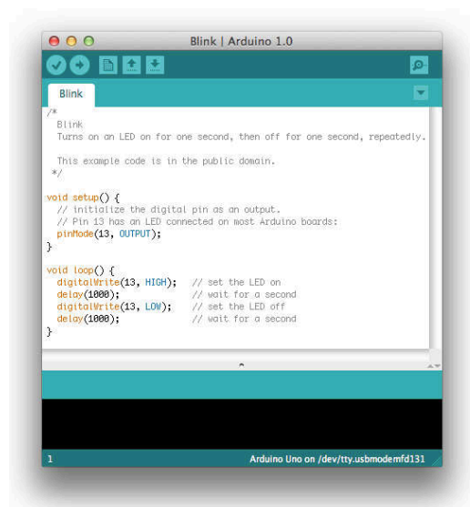
Εικόνα 20: Ο προγραμματισμός νέων διεπαφών με τον χρήστη ήταν μια εξειδικευμένη εργασία που απαιτούσε γνώσεις τόσο υλικού όσο και λογισμικού υπολογιστών. Το ολοκληρωμένο περιβάλλον ανάπτυξης του Arduino περιλαμβάνει βιβλιοθήκες και γλώσσα προγραμματισμού που μοιάζουν με την δημοφιλή C, τα οποία κρύβουν τις λεπτομέρειες του υλικού και επιτρέπουν στον κατασκευαστή να εστιάσει στις νέες λειτουργίες που σχεδιάζει.
