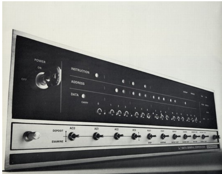
Εικόνα 11: Ακόμη και ο μικρότερος μίνι-υπολογιστής στα τέλη της δεκαετίας του 1960 δεν μοιάζει καθόλου με έναν επιτραπέζιο σύστημα διάδρασης, αφού το βασικό μοντέλο έχει μόνο διακόπτες με φωτάκια και με μια επέκταση μπορεί να συνδεθεί σε έναν τηλετυπο. Αυτό δεν ήταν εμπόδιο για τους ερευνητές του Xerox PARC που με την τεχνική της εξομοίωσης άρχισαν πάνω σε αυτό το μηχάνημα την κατασκευή του λογισμικού για το Alto που είναι πολύ διαφορετικό αφού βασίζεται στο ποντίκι και στην γραφική διεπαφή.
