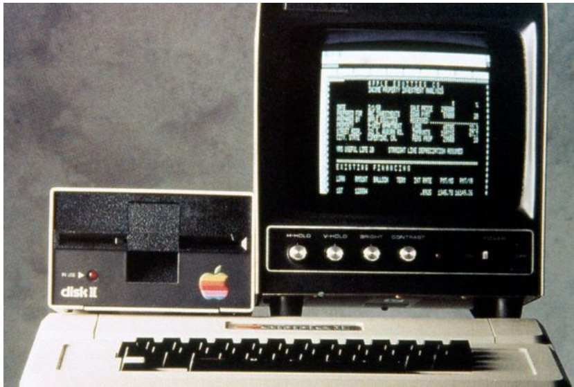
Εικόνα 3: Ο δεύτερος μικροϋπολογιστής της Apple ήταν άμεσα διαθέσιμος σε μια καλαίσθητη συσκευασία βιομηχανικού σχεδιασμού με πληκτρολόγιο και είχε εισόδους και εξόδους για πολλά διαφορετικά περιφερειακά, όπως δίσκοι και οθόνη. Μπορούσε να συνδεθεί σε τηλεόραση και να αποθηκεύσει προγράμματα σε ένα μαγνητόφωνο κασέτας ήχου, οπότε το κόστος ήταν χαμηλό και έγινε αμέσως δημοφιλής, ενώ έμεινε σε παραγωγή για περισσότερα από δεκαπέντε χρόνια.
