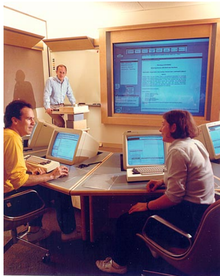
Εικόνα 14: Το τρίτο και μεγαλύτερο σε μέγεθος μέλος της οικογένειας του διάχυτου υπολογισμού του Xerox PARC είναι το Liveboard. Βασίζεται στην είσοδο με πένα και προσομοιώνει τις λειτουργίες των σημειώσεων και της παρουσίασης σε μια μεγάλη οθόνη τοίχου, έτσι ώστε οι ομάδες συνεργασίας να μπορούν να μεταφέρουν χρήσιμη πληροφορία από τα προσωπικά τερματικά τους.
