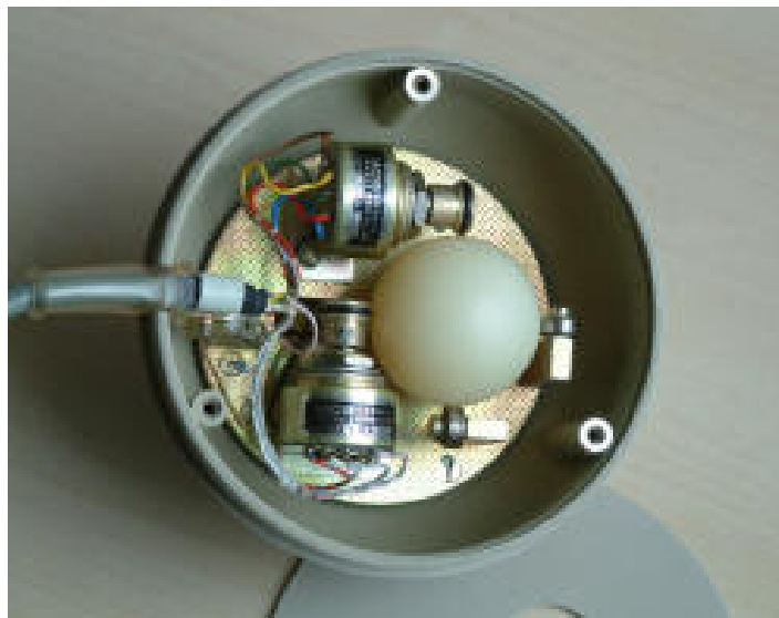
Εικόνα 8: Το αρχικό ποντίκι με τους δύο τροχούς κύλισης που ακουμπάνε απευθείας πάνω στο τραπέζι μπορούσε να επιλέγει κείμενο αλλά δεν ήταν βέλτιστο για την ελεύθερη επιλογή σημείων στην οθόνη, γιατί μπορούσε να κινηθεί μόνο σε οριζόντιες και κατακόρυφες ευθείες γραμμές. Οι μηχανικοί της Telefunken βασιζόμενοι στην σχεδίαση της μπάλας κύλισης, την οποία γύρισαν ανάποδα, έφτιαξαν το πρώτο εύχρηστο ποντίκι για γραφικά περιβάλλοντα.
