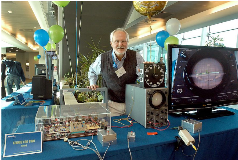
Εικόνα 7: Το βιντεοπαιχνίδι Tennis for Two είναι μια σχετικά πιστή προσομοίωση του τένις για δύο παίκτες όπως αυτό φαίνεται από το πλάϊ σε πρόσοψη. Κατασκευάστηκε σε αναλογικό ηλεκτρονικό υπολογιστή και για την οπτικοποίηση του χρησιμοποιήθηκε ένα φασματοσκόπιο. Η επίδραση του ήταν καταλυτική αφού έδωσε την έμπνευση για το δημοφιλές Pong, ενώ για πολλές δεκαετίες μετά τα βιντεοπαιχνίδια προσομοίωσης αθλημάτων παραμένουν πολύ δημοφιλή.
