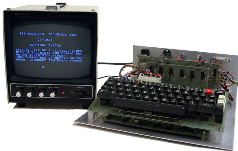
Εικόνα 9: Η μεγάλη διαθεσιμότητα των συσκευών τηλεόρασης την δεκαετία του 1970 επέτρεψε σε πολλούς ερασιτέχνες να συνδέσουν ένα πληκτρολόγιο για να γράψουν κείμενο στην οθόνη της. Αν και οι συσκευές αυτές δεν είχαν κάποιο επεξεργαστή, στην συνέχεια επεκτάθηκαν για να συνδεθούν με τους πρώτους μικροϋπολογιστές.
