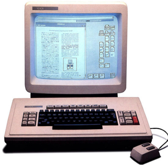
Εικόνα 19: Ο επιτραπέζιος υπολογιστής με πληκτρολόγιο, ποντίκι, και γραφική επιφάνεια εργασίας (παράθυρα, εικονίδια, φάκελοι) που δημιουργήθηκε από τη Xerox στα τέλη της δεκαετίας του 1970 λίγο διαφέρει από τον μοντέρνο επιτραπέζιο υπολογιστή.
