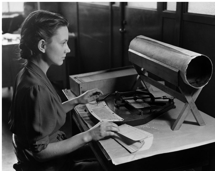
Εικόνα 9: Τα συστήματα διάτρησης κάρτας υπάρχουν από τον 19ο αιώνα με βασικές εφαρμογές τον προγραμματισμό και αποθήκευση δεδομένων για μηχανήματα πλεξίματος και αναπαραγωγής μουσικής, οπότε υπήρχε η τεχνογνωσία για την προσαρμογή τους ως συσκευές εισόδου στους πρώτους κεντρικούς ηλεκτρονικούς υπολογιστές.
