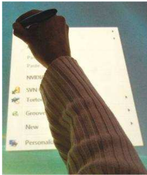
Εικόνα 15: Η άμεση διάδραση με συσκευές αφής έχει το μειονέκτημα ότι το χέρι ή τα δάκτυλα μπορεί να καλύπτουν τον στόχο (ή το αντικείμενο) που θέλουμε να επιλέξουμε ή και να μετακινήσουμε, φαινόμενο γνωστό ως occlusion (έμφραξη), εκτός αν αυτό είναι αρκετά μεγάλο ή χρησιμοποιηθούν τεχνικές που αναιρούν το occlusion.
