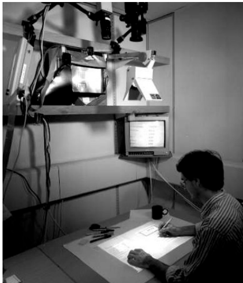
Εικόνα 13: Το σύστημα Digital Desk δημιουργήθηκε στις αρχές του 1990 με στόχο να φέρει τις δυνατότητες διάδρασης μεταξύ του ψηφιακού και φυσικού κόσμου πάνω στο τραπέζι, ακριβώς δηλαδή, το αντίθετο από την κατεύθυνση που ακολουθεί ο επιτραπέζιος υπολογισμός από το 1980.
