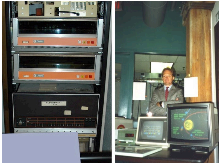
Εικόνα 9: Η αρχική υλοποίηση του προγράμματος ψηφιακής επεξεργασίας εικόνας Superpaint έγινε σε γλώσσα μηχανής στον μίνι υπολογιστή Data General Nova, ο οποίος ήταν συνδεδεμένος με επιπλέον υλικό για την ψηφιοποίηση αναλογικού βίντεο καθώς και για την είσοδο και έξοδο του προγράμματος ψηφιακής ζωγραφικής. Η προβολή των εικόνων γινόταν σε μια αναλογική οθόνη τηλεόρασης, ενώ για την επεξεργασία της εικόνας η βασική συσκευή εισόδου ήταν μια πένα έμμεσης διάδρασης. Η τεχνολογία αυτή αναπτύχθηκε παράλληλα με τα γραφικά περιβάλλοντα και οδήγησε σε εφαρμογές ψηφιακής τέχνης και ψηφιακής κινηματογραφίας.
