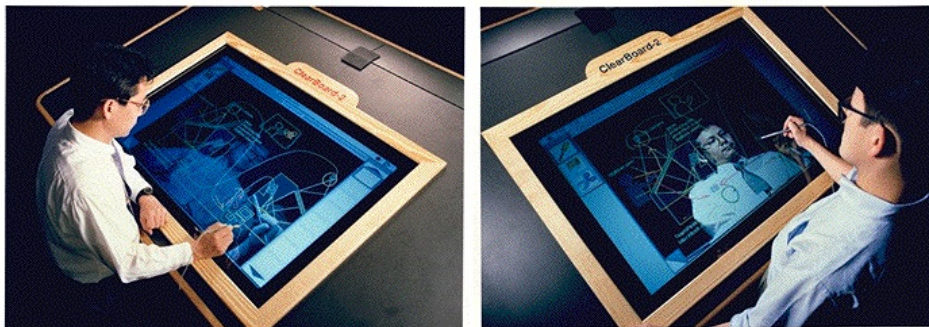
Εικόνα 14: Το σύστημα συνεργασίας Clearboard του MIT Media Lab προβάλλει το βίντεο από δύο συνεργάτες πάνω στην κοινή εφαρμογή ζωγραφικής, έτσι ώστε να υπάρχει σύγχρονη επίγνωση του βλέματος και των χειρονομιών.
