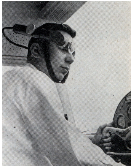
Εικόνα 11: Η προβολή βίντεο πάνω σε έναν διάφανο φακό που βρίσκεται στερεωμένος σε ένα κράνος πιλότου ελικοπτέρου χρησιμοποιήθηκε από τον στρατό για να διευκολύνει την προσγείωση ελικοπτέρων με την βοήθεια κάμερας σε δύσκολες συνθήκες. Αυτό το σύστημα επεκτάθηκε τα επόμενα χρόνια ώστε, αντί για βίντεο, να προβάλλει γραφικά, τα οποία μετασχηματίζονταν ανάλογα με την κίνηση του κεφαλιού.
