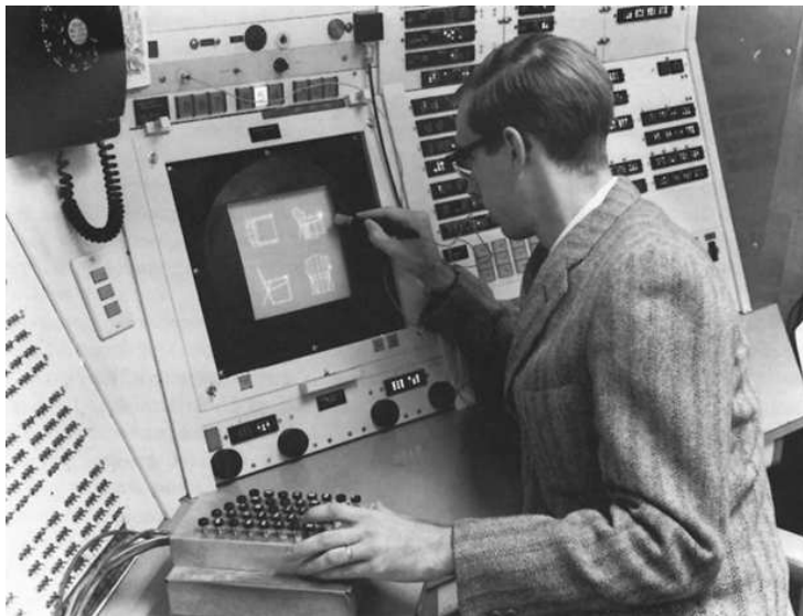
Εικόνα 8: Το σύστημα Sketchpad θεωρείται το πρώτο σημαντικό σύστημα αλληλεπίδρασης ανθρώπου και υπολογιστή με χρήση γραφικών. Οι κεντρικοί υπολογιστές εκείνης της εποχής συνήθως βασίζονταν σε διάτρητες κάρτες ή σε τερματικά γραμμής. Με αυτόν τον τρόπο, το Sketchpad έδειξε ότι είναι εφικτό να έχουμε έναν υπολογιστή, ο οποίος να μην αλληλεπιδρά με τον χρήστη με τον τρόπο που βολεύει μόνον τον υπολογιστή.
