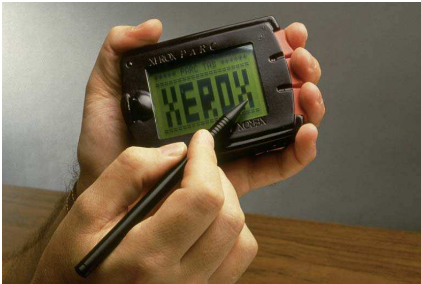
Εικόνα 5: Η συσκευή τύπου Tab ήταν η μικρότερη στην οικογένεια συσκευών διάχυτου υπολογισμού Tab-Pad-Board και ήταν σχεδιασμένη έτσι ώστε να χωράει στην παλάμη και να μπορεί να λειτουργήσει τα κουμπιά μόνο με το ένα χέρι, ενώ επέτρεπε και την αφή με το δεύτερο χέρι με την χρήση μιας πέννας.
