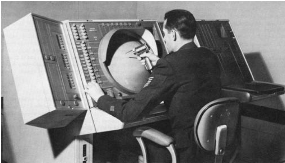
Εικόνα 7: Ένας από τους μεγαλύτερους σε μέγεθος και πολύ ισχυρός υπολογιστής της δεκαετίας του 1950 ήταν ο SAGE (Semi-Automatic Ground Environment), ο οποίος συγκέντρωνε τα δεδομένα πτήσεων από ένα δίκτυο ραντάρ και τα πρόβαλε στην οθόνη μαζί με απλά γραφικά χάρτη. Ο χρήστης μπορούσε να επιλέξει ένα σημείο στο ραντάρ με την βοήθεια μια αρχικής μορφής πέννας, για να ταυτοποιήσει το αντίστοιχο αντικείμενο.
