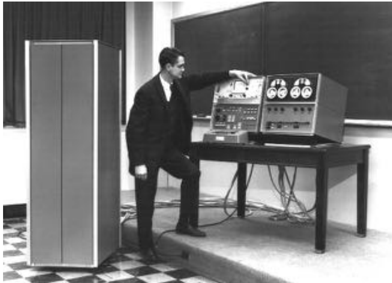
Εικόνα 10: Ο LINC (Laboratory INstrument Computer) θεωρείται ο πρώτος προσωπικός υπολογιστής, γιατί σε έναν σχετικά μικρό όγκο περιλαμβάνει συσκευή εξωτερικής αποθήκευσης και κυρίως οθόνη και πληκτρολόγιο ως σύστημα εξόδου και εισόδου. Σε αντίθεση με τους μεγάλους κεντρικούς υπολογιστές εκείνης της εποχής, ήταν σχεδιασμένος από την αρχή σε συναρμολογούμενη μορφή, οπότε ήταν σχετικά προσιτός σε πολλά ερευνητικά εργαστήρια που είχαν τις δεξιότητες να τον κατασκευάσουν και να τον συντηρήσουν.
