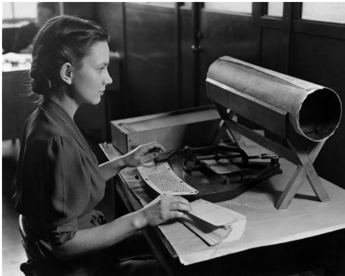
Εικόνα 9: Τα συστήματα διάτρησης κάρτας υπάρχουν από τον 19ο αιώνα με βασικές εφαρμογές τον προγραμματισμό και αποθήκευση δεδομένων για μηχανήματα πλεξίματος και αναπαραγωγής μουσικής, οπότε υπήρχε η τεχνογνωσία για την προσαρμογή τους ως συσκευές εισόδου στους πρώτους κεντρικούς ηλεκτρονικούς υπολογιστές.
