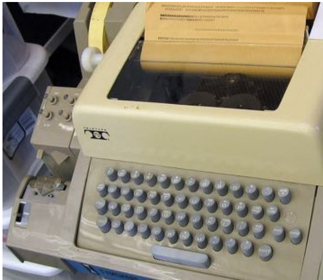
Εικόνα 3: Το μοντέλο 33 της εταιρείας Teletype αποτελεί μια ολοκληρωμένη συσκευή εισόδου και εξόδου και ήταν πολύ δημοφιλής με τους μίνι-υπολογιστές της δεκαετίας του 1960, καθώς και με τους πρώτους μικρο-υπολογιστές, αφού για πολλά χρόνια ήταν η πιο οικονομική και οικεία λύση. Ο χρήστης μπορούσε να αλληλεπιδράσει με τον υπολογιστή με το πληκτρολόγιο και να δει την έξοδο να τυπώνεται στο χαρτί, ενώ η διάτρητη χαρτοταινία επιτρέπει τόσο την αποθήκευση δεδομένων, όσο και την φόρτωση τους.
