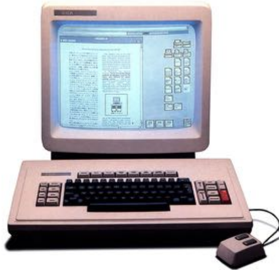
Εικόνα 19: Ο επιτραπέζιος υπολογιστής με πληκτρολόγιο, ποντίκι, και γραφική επιφάνεια εργασίας (παράθυρα, εικονίδια, φάκελοι) που δημιουργήθηκε από τη Xerox στα τέλη της δεκαετίας του 1970 λίγο διαφέρει από τον μοντέρνο επιτραπέζιο υπολογιστή.
