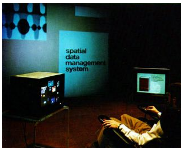
Εικόνα 10: Στο ερευνητικό έργο Spatial Data Management System η πλοήγηση σε πολυμεσική πληροφορία μπορεί να γίνει με μια μεταφορά που βασίζεται στην πλοήγηση στο φυσικό περιβάλλον με την προσθήκη της δυνατότητας μεγέθυνσης και μιας ιεραρχικής οργάνωσης των δεδομένων. Ο χρήστης πλοηγείται με τα ενσωματωμένα σε μια καρέκλα χειριστήρια και χρησιμοποιεί συμπληρωματικές οθόνες, οι οποίες μπορούν να μεγεθύνουν και να εφαρμόσουν εργαλεία πάνω στα πολυμεσικά δεδομένα.
