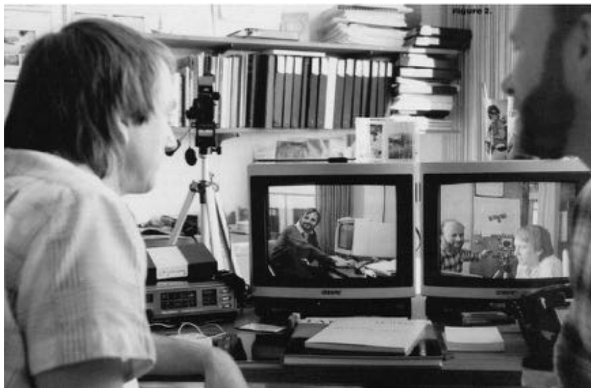
Εικόνα 14: Το ερευνητικό πρόγραμμα Media Space ήταν μια από τις πρώτες προσπάθειες ανθρώπινης συνεργασίας από απόσταση μέσω υπολογιστή, το οποίο χρησιμοποιούσε ζωντανή εικόνα βίντεο.
