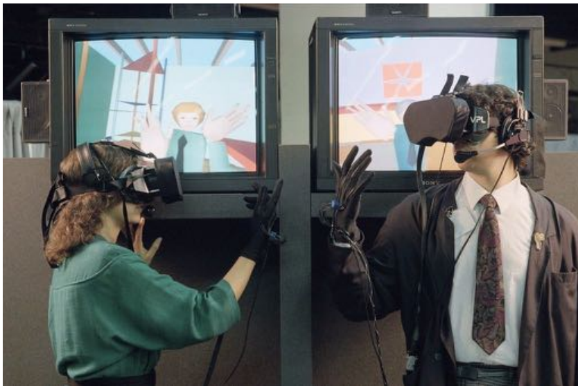
Εικόνα 22: Το γάντι δεδομένων περιέχει αισθητήρες που καταγράφουν την θέση του χεριού και τις κινήσεις των δακτύλων, έτσι ώστε να υπάρχει λεπτομερής χειρισμός στο περιβάλλον εικονικής πραγματικότητας που απεικονίζεται στην μάσκα. Η δυνατότητα του χρήστη όχι μόνο να πλοηγηθεί, αλλά κυρίως να εκφραστεί σωματικά και να χειριστεί με μεγάλη ακρίβεια τον εικονικό εαυτό και περιβάλλον του, στο οποίο συνεργάζεται και με άλλους χρήστες, ήταν τα θεμέλια στο πρώτο εμπορικό σύστημα εικονικής πραγματικότητας.
